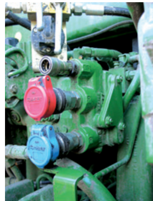
▲ De power beyond plaat op de trekker met snelkoppeling 1 / 2 en boven de load-sensing snelkoppeling.
