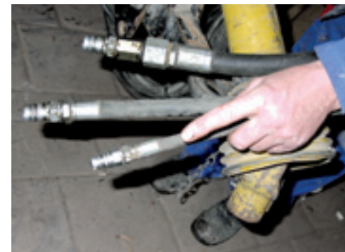
▲ Een load sensing (LS) aansluiting van het werktuig is te herkennen door een grote retourslang en de specifieke dunne LS-leiding. Door de snelsluitingen omgekeerd te monteren, zijn aansluitfouten te voorkomen.
